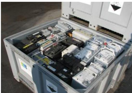
Photo 1 - Récupération des batteries à régénérer (bac polyéthylène)
